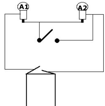
a. Quand l'interrupteur est ouvert, on observe l'état des ampoules A1 et A2. Complète le tableau en mettant une croix dans la case qui convient sur chaque ligne :
