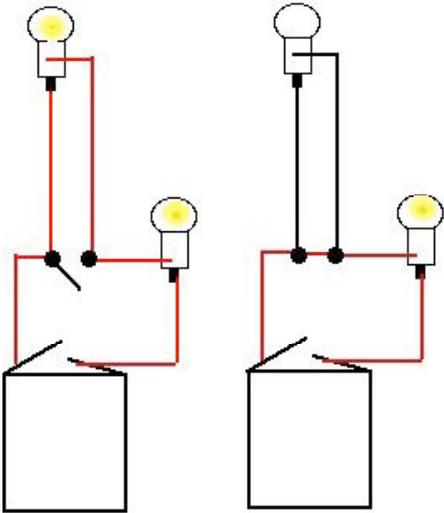
Les élèves font une dérivation sur l'interrupteur. Lorsqu'il est ouvert le circuit est un circuit série, par contre lorsque l'interrupteur est fermé, le courant électrique lorsqu'il a le "choix" entre 2 boucles non équivalentes, circule dans la boucle où il y a le moins "d'obstacle". Dans ce cas le courant ne va pas dans la boucle du haut, car passé la première ampoule, il y en a une seconde, il "choisit" donc la boucle avec une seule ampoule.
