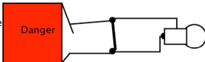
Attention n'est pas forcément un circuit plus court, il s'agit d'une boucle dans la quelle il n'y a aucun élément récepteur (type ampoule, moteur, buzzer ...)
