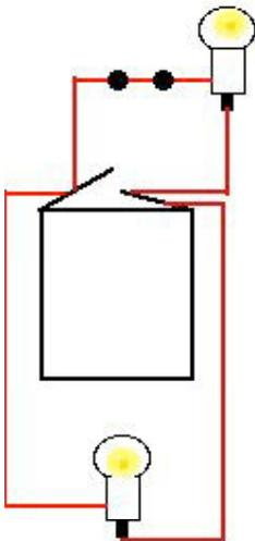
Si l'on dévisse une ampoule, l'autre continue d'éclairer, mais l'interrupteur, ne commande qu'une ampoule...
